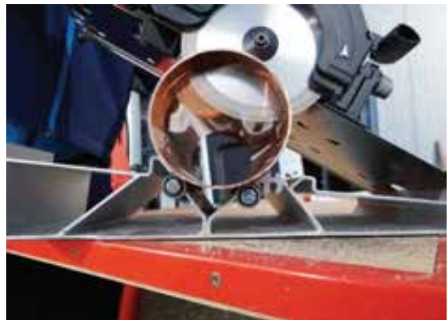
Функция зажима позволяет быстрее резать различные материалы
